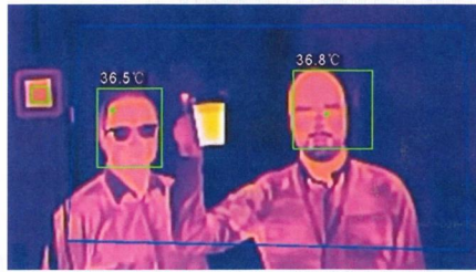
▶ 温度測定範囲内にあるコップは測定せず、顔のみを検出し、温度測定します
